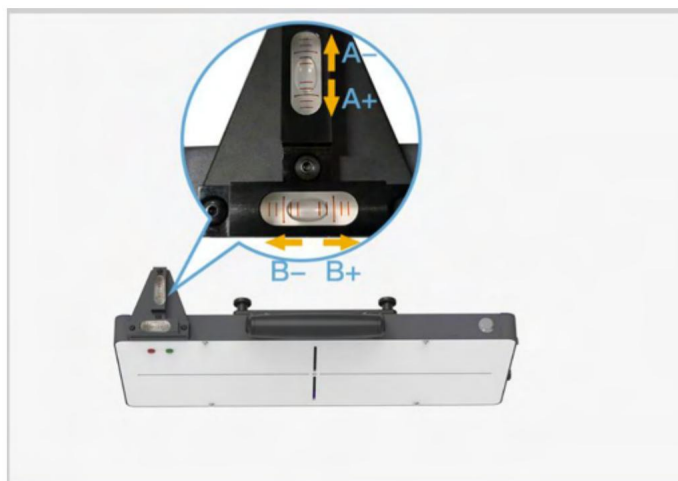
Obrázek 6-129 Vycentrování bubliny na vodováze
