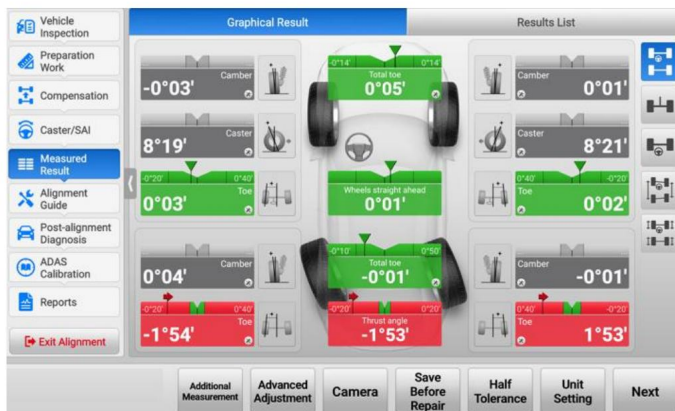
Obrázek 4-48 Obrazovka s výsledky měření (grafické znázornění výsledků)
