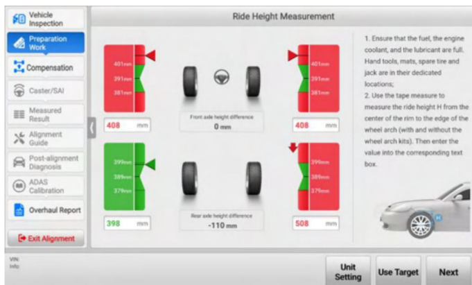
Obrázek 4-30 Měření výšky jízdy pomocí pásma 1
