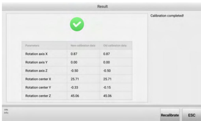
Obrázek 5-39 Obrazovka s výsledky kalibrace (použití vozidla)
