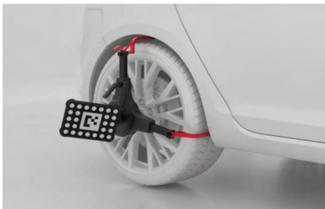
Obrázek 6-137 Instalace svorek kol (svorek pneumatik) a terčů
