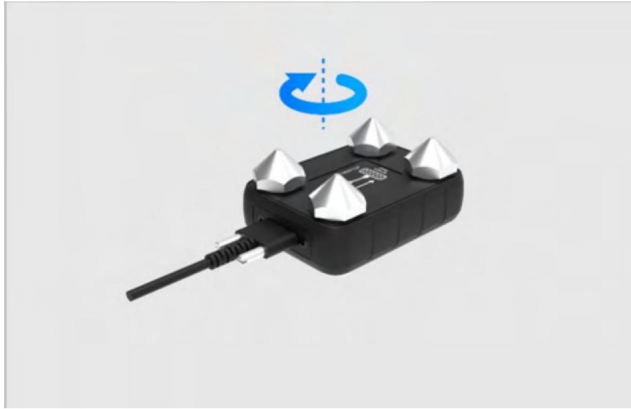
Obrázek 5-10 Provedení kalibrace ručního inklinometru 4
