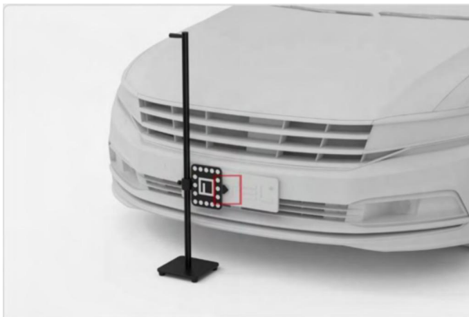
Obrázek 6-123 Umístění zarovnávací pomůcky
