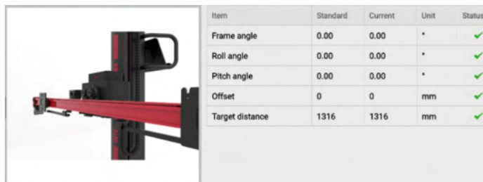
Obrázek 6-113 Přesunutí příčné tyče do cílové polohy
