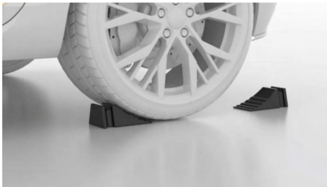
Obrázek 6-42 Umístění klínů pod kola
