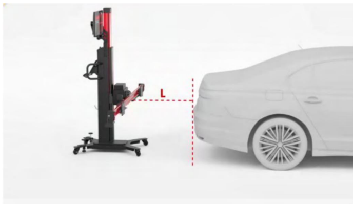
Obrázek 6-30 Vycentrování kalibračního rámu
