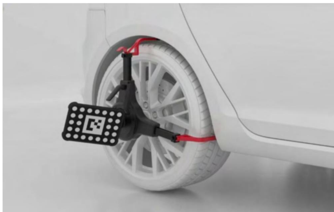
Obrázek 6-109 Instalace svorek kol (svorek pneumatik) a terčů
