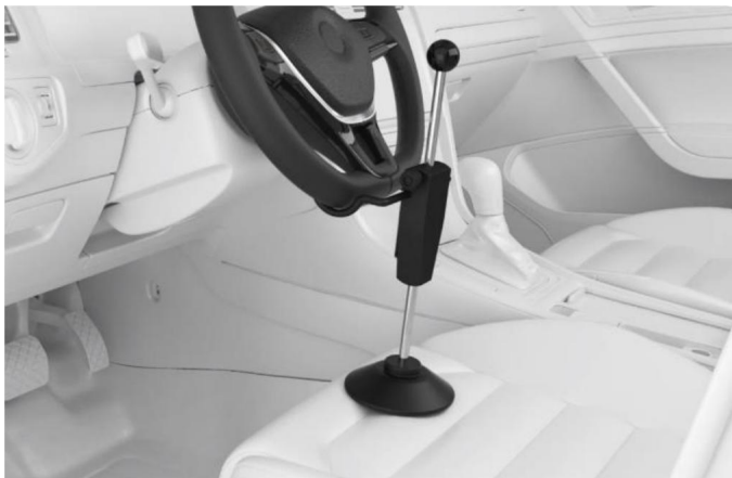
Obrázek 6-43 Instalace nástroje pro držák volantu
