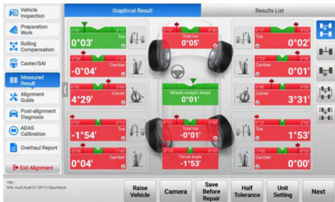
Obrázek 5-86 Obrazovka naměřených výsledků (plná tolerance)
