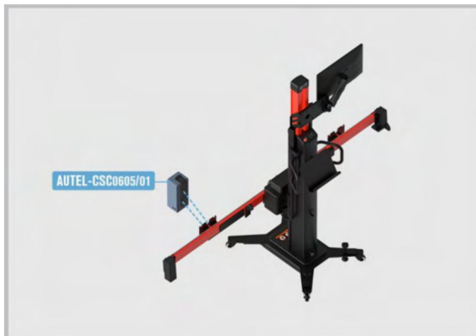
Obrázek 6-34 Instalace kalibrační krabice radaru na levou posuvnou desku
