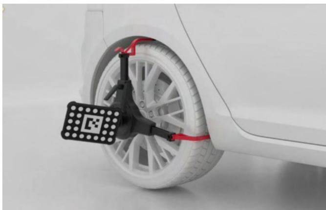
Obrázek 6-149 Instalace svorek kol (svorek pneumatik) a cílů
