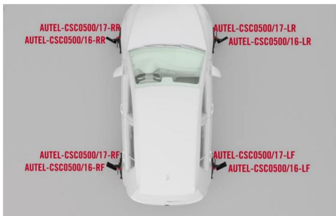
Obrázek 6-45 Instalace svorek kol (svorek pneumatik) a cílů
