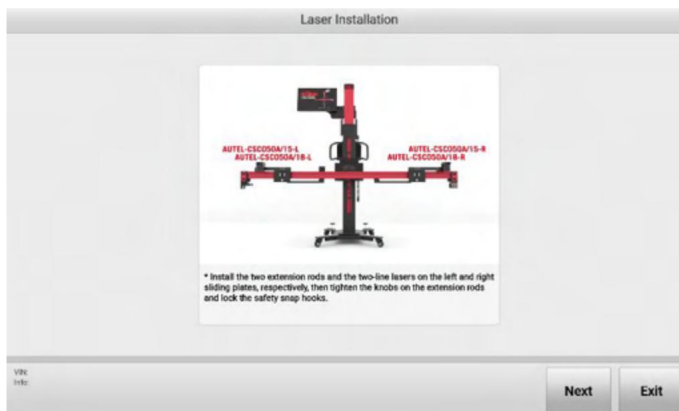
Obrázek 5-70 Instalace dvouřádkových laserů
