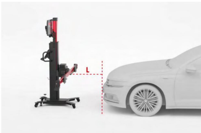
Obrázek 6-136 Vycentrování kalibračního rámu
