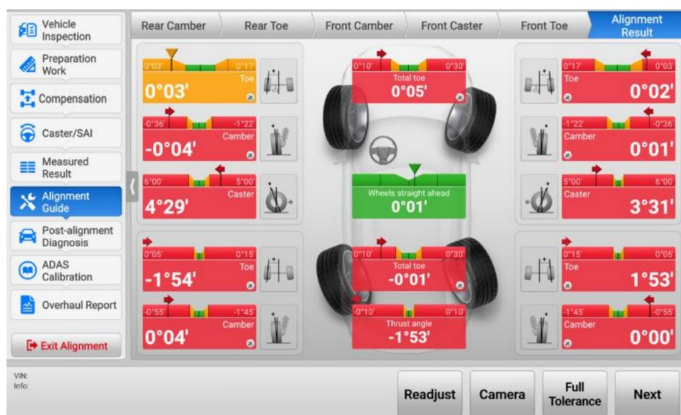
Obrázek 4-64 Obrazovka s výsledky zarovnání
