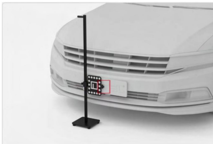
Obrázek 6-110 Umístění zarovnávací pomůcky
