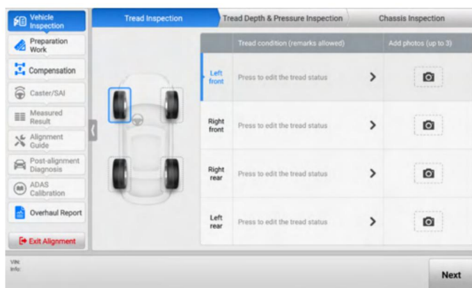
Obrázek 4-14 Obrazovka kontroly běhounu
