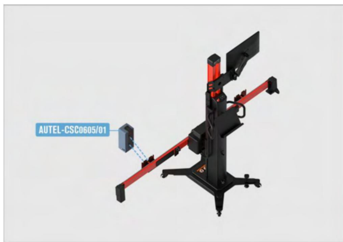
Obrázek 6-52 Instalace kalibračního boxu radaru na levou posuvnou desku
