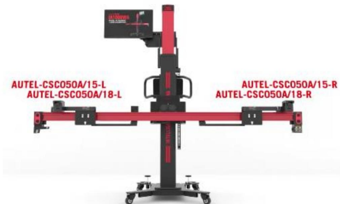
Obrázek 6-79 Instalace prodlužovacích tyčí a dvouřádkových laserů
