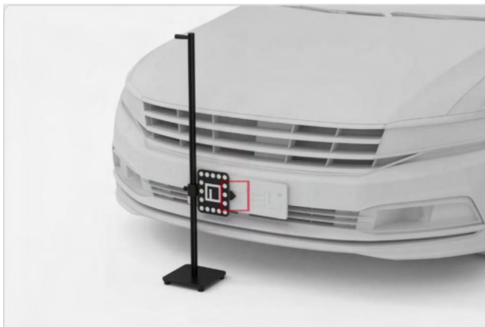
Obrázek 6-97 Umístění zarovnávací pomůcky
