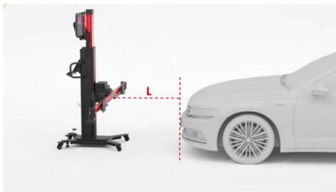
Obrázek 6-3 Vycentrování kalibračního rámu
