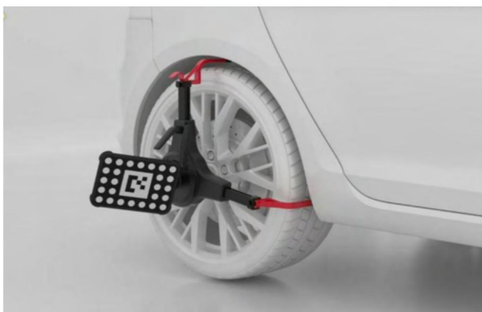
Obrázek 6-96 Instalace svorek kol (svorek pneumatik) a terčů
