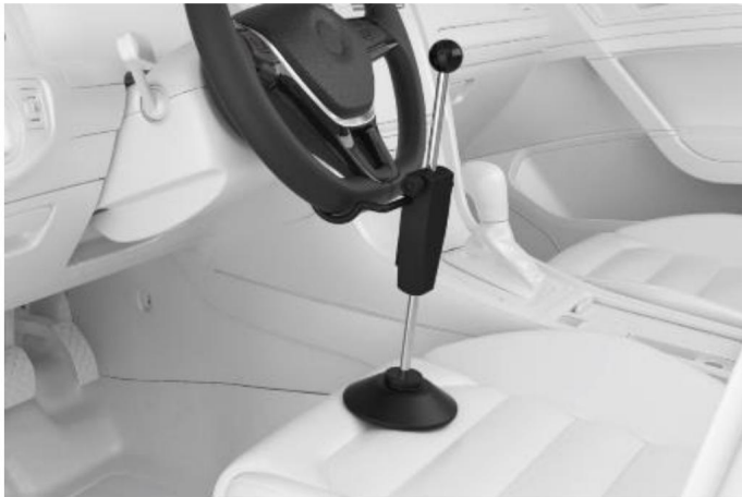
Obrázek 6-76 Instalace nástroje pro držák volantu
