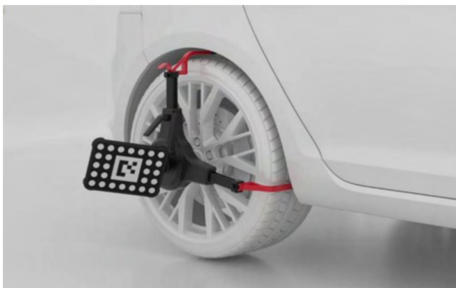
Obrázek 6-122 Instalace svorek kol (svorek pneumatik) a terčů
