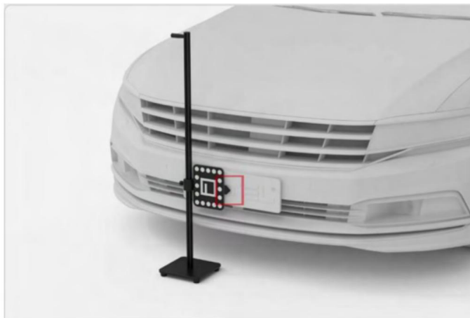
Obrázek 6-5 Umístění zarovnávací pomůcky
