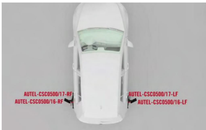
Obrázek 6-31 Instalace svorek kol (svorek pneumatik) a terčů
