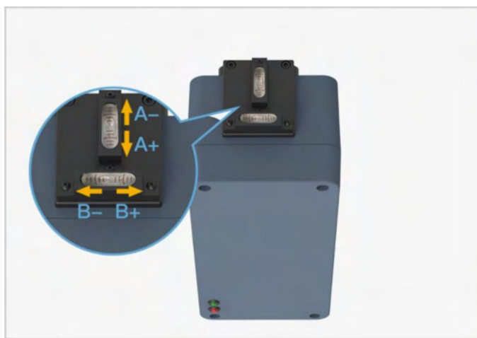
Obrázek 6-56 Vycentrování bubliny na vodováze
