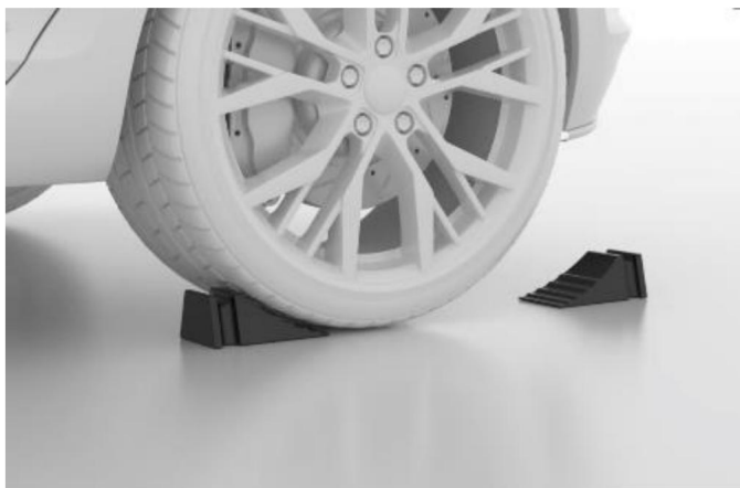
Obrázek 6-146 Umístění klínů pod kola
