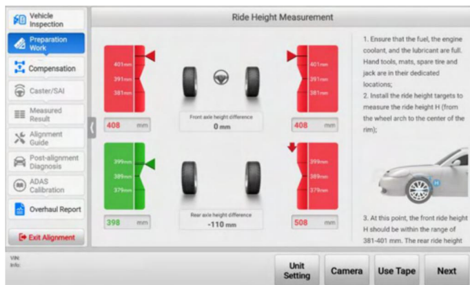
Obrázek 4-33 Měření výšky jízdy s cílovou hodnotou výšky jízdy
