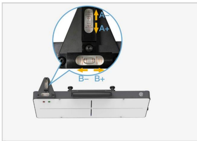
Obrázek 6-103 Vycentrování bubliny na vodováze
