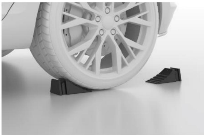
Obrázek 6-75 Umístění klínů pod kola
