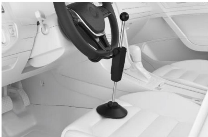
Obrázek 6-147 Instalace nástroje pro držák volantu
