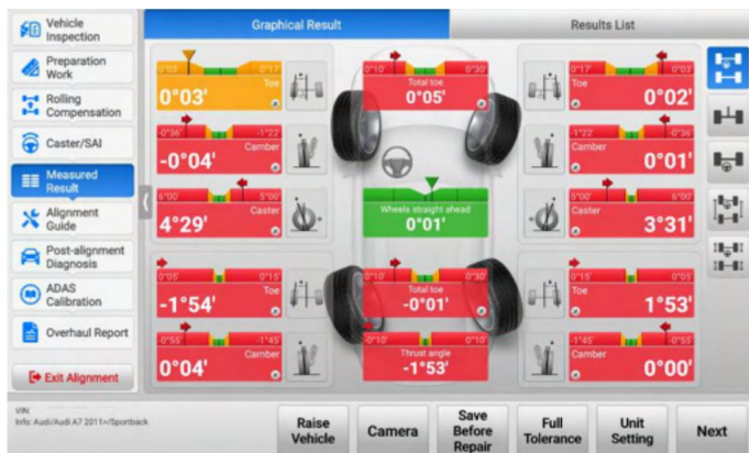
Obrázek 5-85 Obrazovka naměřených výsledků (poloviční tolerance)
