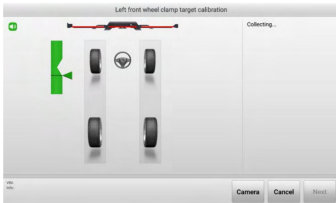
Obrázek 5-38 Spuštění kalibrace (použití vozidla) 4
