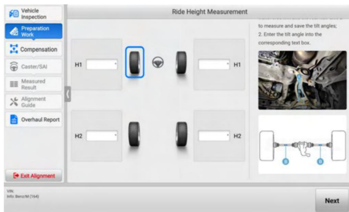
Obrázek 4-34 Měření a zadání úhlů náklonu
