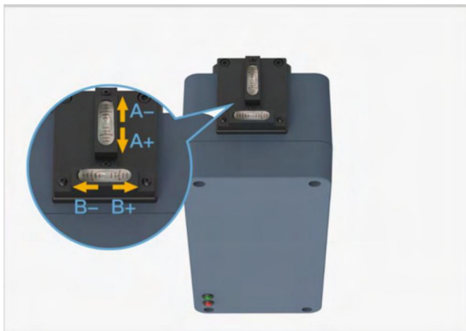
Obrázek 6-35 Vycentrování bubliny na vodováze
